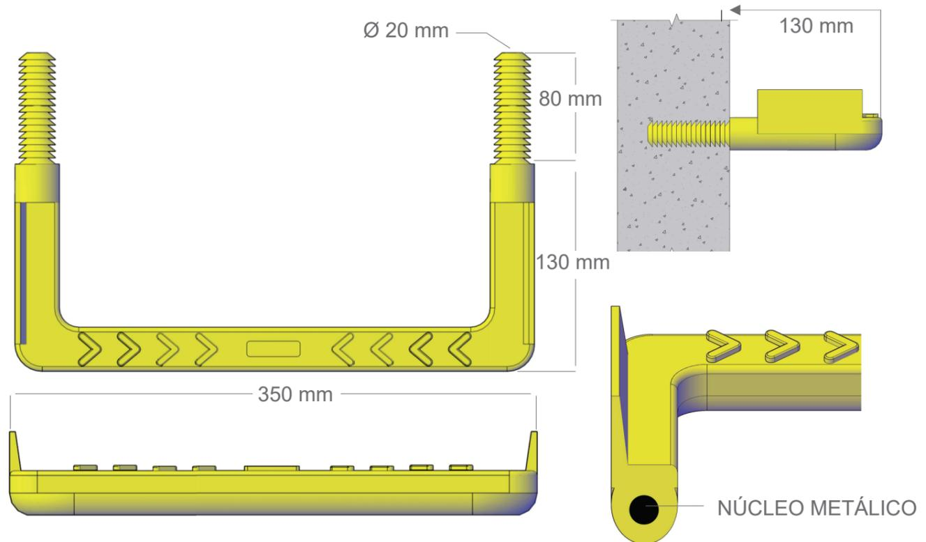
Os degraus para escada de serviço são usados como meio de acesso para facilitar entrada e saída de pessoas em estruturas subterrâneas, como tanques, poços de visita, elevatórias, caixas para elétrica e de comunicação, detenção/retenção/acumulação/amortecimento pluvial e outros.
